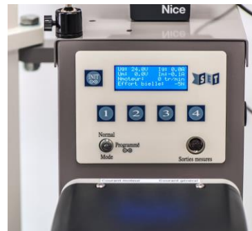
Panneau de contrôle et de commande sur base Arduino
